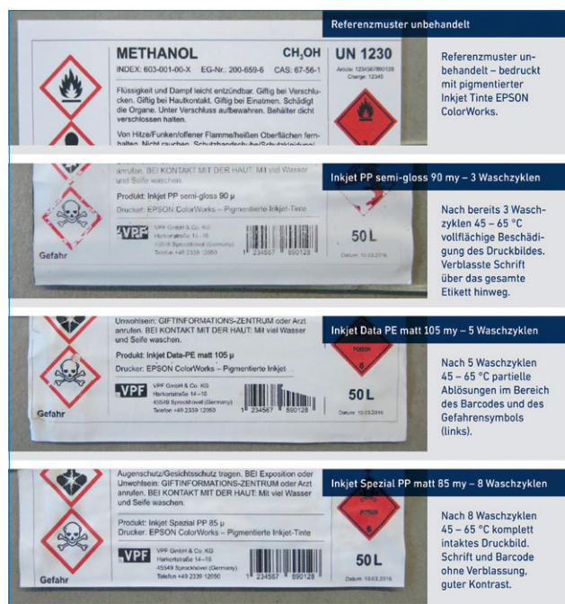
Beständigkeit verschiedener Inkjet-Folien im Vergleich zum unbehandelten Referenzmuster
