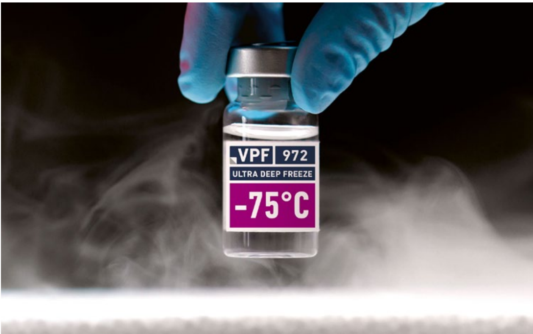
VPF 60659 PP weiß glänzend mit Klebstoff 972, 18\text{ g/m}^2 nach der Lagerung bei -75^{\circ}\text{C} .
