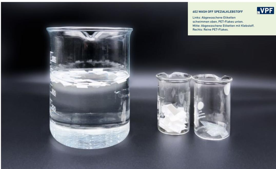
Trennung nach der Dichte: Mit dem Klebstoff „Wash Off 602“ beschichtete rPE Folie weiß (71786) nach dem Waschprozess.
